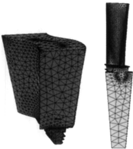
图 2 有限元模型 Fig. 2 Finite element method model
